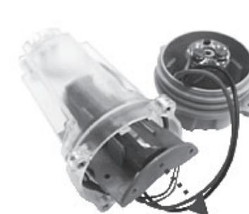
3. Use el destornillador Philips para destornillar los tornillos de la cámara principal. Saque la mitad superior de la cámara principal para exponer el compartimiento de la batería.
