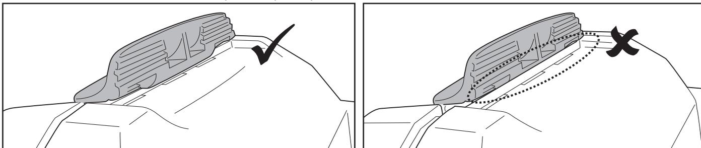
**CONSEILS:** Avant de re-utiliser le robot, tenez les clips latéraux sur le couvercle pour faire légèrement osciller le robot, afin de vous assurer que le couvercle est fixé à la base.
