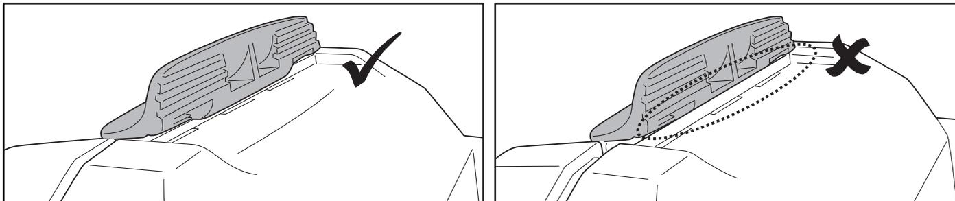
**TIPS:** Voordat u de robot opnieuw in het zwembad plaatst, houdt u de vleugels op het bovendeksel van de behuizing vast om de robot een beetje te laten zwaaien, zodat het bovendeksel aan de basis wordt bevestigd.
