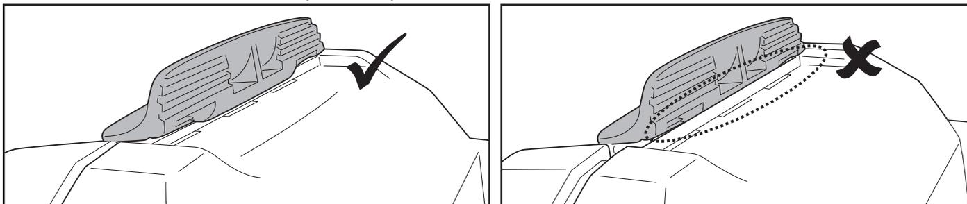
**SUGGERIMENTI:** Prima di ricollocare il robot nella piscina, afferrare le ali dal coperchio superiore del corpo e scuotere leggermente il robot, per garantire che il coperchio superiore sia fissato alla base.
